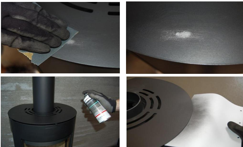
**WICHTIG: NACH DER VERWENDUNG DEN LACK MIN. 8 STUNDEN TROCKNEN LASSEN.**
