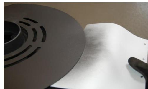
**ATTENZIONE : DOPO L’APPLICAZIONE LASCIARE ASCIUGARE LA VERNICE PER ALMENO 8 ORE. ALLA SUCCESSIVA ACCENSIONE DELLA STUFA EFFETTUARE UN CARICO DA 2,5KG CIRCA E REGOLARE AL MASSIMO LA POTENZA DELLA STUFA PER PERMETTERE L’ATTIVAZIONE DELLA VERNICE.**
